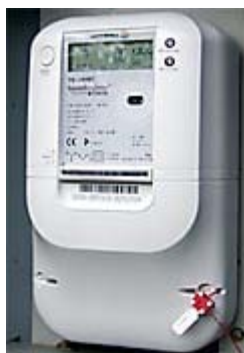
CAJA con emisor GPRS y sistema PLC
